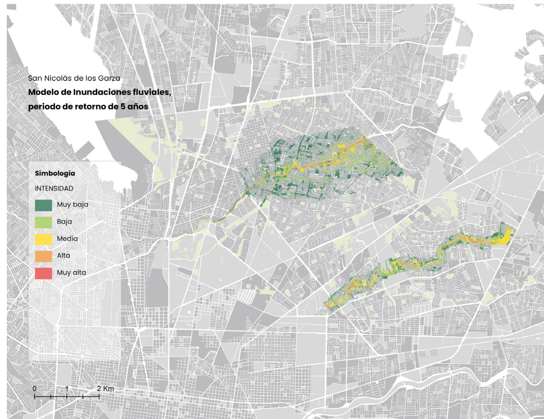
Mapa 3. Modelo de inundaciones fluviales (vuelo superficie) por profundidad máxima para un periodo de acumulación de 24 horas sobre los arroyos Topo Chico y Los Pinos, periodo de retorno de 5 años
